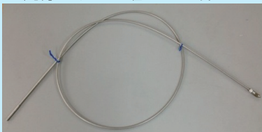
単芯光ファイバ コア径 \Phi 1.2mm 長さ 2m
