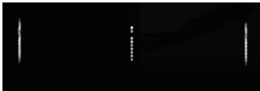
検知器受光面の中心は良いが、両端では空間分解能が低下している
