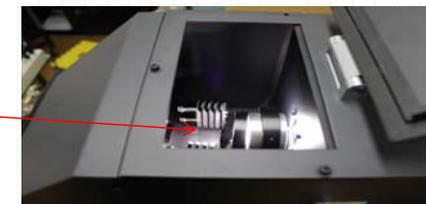
光学系にはフィルタホルダを搭載し、最大4枚を同時に使用出来ます。NDフィルタを使用した減光時の光劣化や、カラーフィルタを使用した波長別の光劣化なども可能です。（NDフィルタ・カラーフィルタはオプション）
