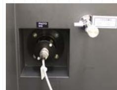
光学系の内部にモニタ検知器を搭載しています。照射光強度をモニタし、キセノン電源へフィードバックすることで、光量を一定に保ちます。
