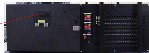
光照射中に試料の観察したい時、恒温器の扉を開けてしまうと温度制御が出来ません。そこで観察窓により恒温器内の設定温度を保ったまま、試料観察が出来ます。
