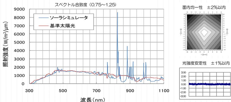
照射光源として使用しているのは、ソーラシミュレータ JIS C8912/C8333 Aクラスより精度の高い疑似太陽光下での耐光性試験が可能です。
