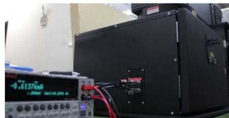
恒温器内と外にBNCコネクタを内蔵。温度雰囲気下でI-V測定が可能
